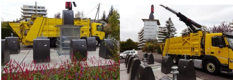
Une benne de surface est composée d'un réceptacle métallique directement posé au sol. Il est soulevé du sol à chaque collecte pour être vidé de ses déchets dans le camion.
