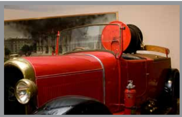
Delahaye (1924) Fourgon premier-secours - pompe 1000 l/min à 8bar
