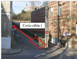
La longueur de la ligne est estimée à 92m, en ligne droite avec une pente constante de 14% : il n'y a aucune contrainte technique pour l'installation du système mécanique. La largeur du trottoir (1.2m) est suffisante pour intégrer la structure de ligne. Une partie des pavés sera enlevée pour installer le matériel de ligne. Le traitement des eaux de surface sera à réaliser après installation.
