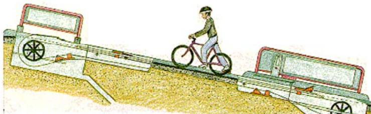
**Fig. 2. Coupe de principe sur le dispositif « Trampe »**
