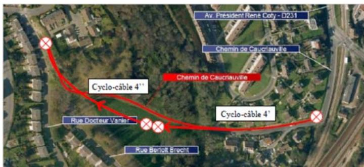
Une autre solution pourrait consister à ne conserver que la portion de tracé hors route, soit environ 270m. Cette longueur est proche des limites techniques acceptables pour un cyclo-câble Skirail. Une étude détaillée est à réaliser pour valider cette solution.
