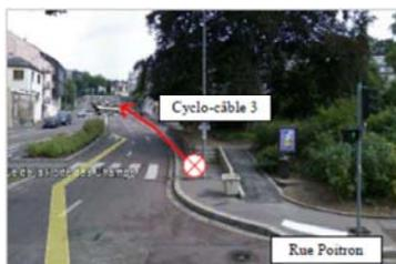
La longueur de la ligne est estimée à 185m, en ligne droite avec une pente variée de 7 à 9% : il n'y a aucune contrainte technique pour l'installation du système mécanique.
